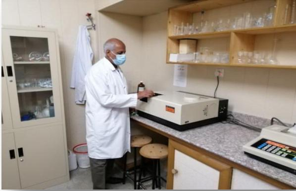
يستند العمل في هذا المختبر على المطيافية الضوئية لأجهزة متنوعة أهمها: مطيافية التفلور Fluorescence Spectrophotometry الذي يعمل وفق مبدأ التفلور التي تستخدم للقياسات النوعية والكمية. التحليل الكمي هو السائد حيث يستخدم لإيجاد تراكيز المواد التي لديها القدرة على التفلور (الصف) مثل المركبات الهيدروكربونية ذات الحلقات البنزينية المتلاصقة وبعض المعقدات للمركبات العضوية التي ترتبط بالعناصر الثقيلة مثل الزئبق واليورانيوم ومواد أخرى حيث معظم
