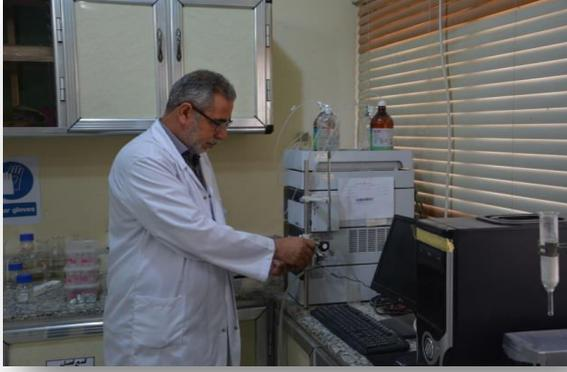
يتوفر في المختبر جهاز كروماتوغرافيا السائل عالي الكفاءة High Performance Liquid chromatography (HPLC) نوع Shimadzu ياباني المنشأ والذي يتكون من جزء اساسي يضم مكونات الجهاز الأساسية وملحقات للجهاز والمتمثلة بحاسبة وطابعة. والذي يعنى بدراسة الهيدروكربونات النفطية وهي ملوثات من اصل نفطي.
